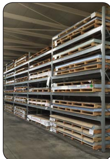
Scaffalatura per pallet fuori misura.
